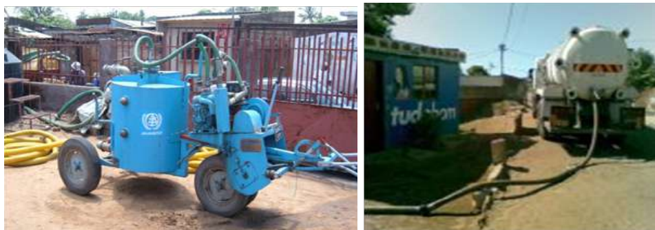
Figura 21: Equipamento para a recolha mecânica de lamas (Vacutug e camião sucção)
